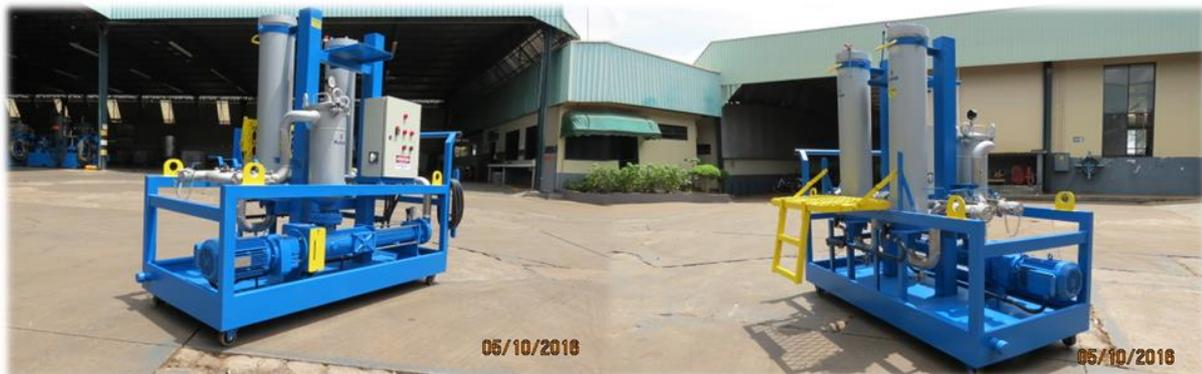
Dois filtros absolutos  $\beta_{10}=150$  e  $\beta_5=300$  para 1.500 lpm e capacidade de retenção de até 1.200g foram escolhidos, para evitar a troca constante de elementos filtrantes e garantir nível de pureza NAS 6.
